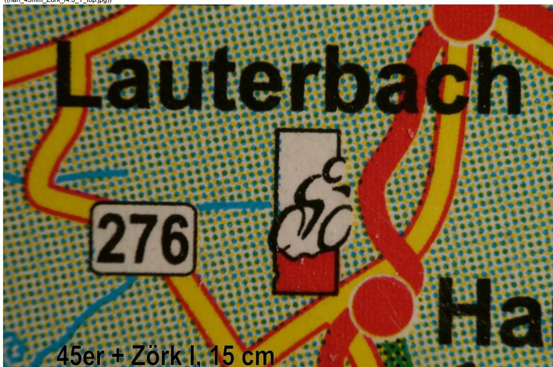
Die Randunschärfe verschwindet sogar nahezu, wenn der Zörk I in Retrostellung eingesetzt wird, was durch die praktischen, doppelt vorhandenen Gewinde einfach möglich ist.
